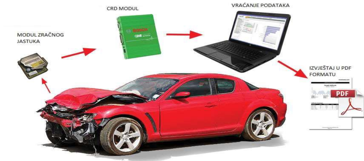
Slika 4. Shematski prikaz čitanja podataka iz EDR uređaja
