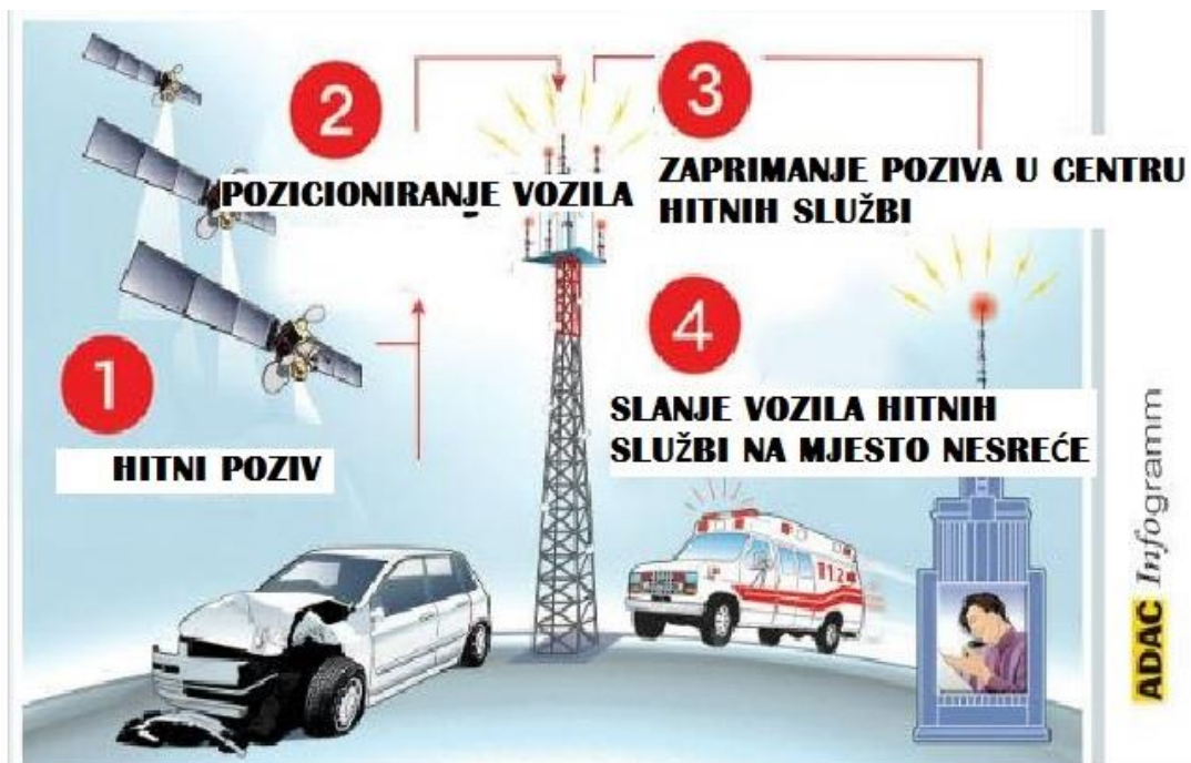
Slika 6. Shematski prikaz E – poziva
