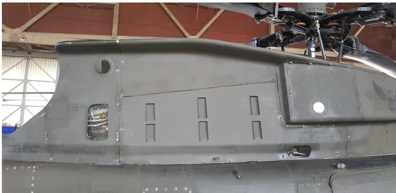
Slika 22. Kućište motora i ispušne cijevi helikoptera OH-58D
