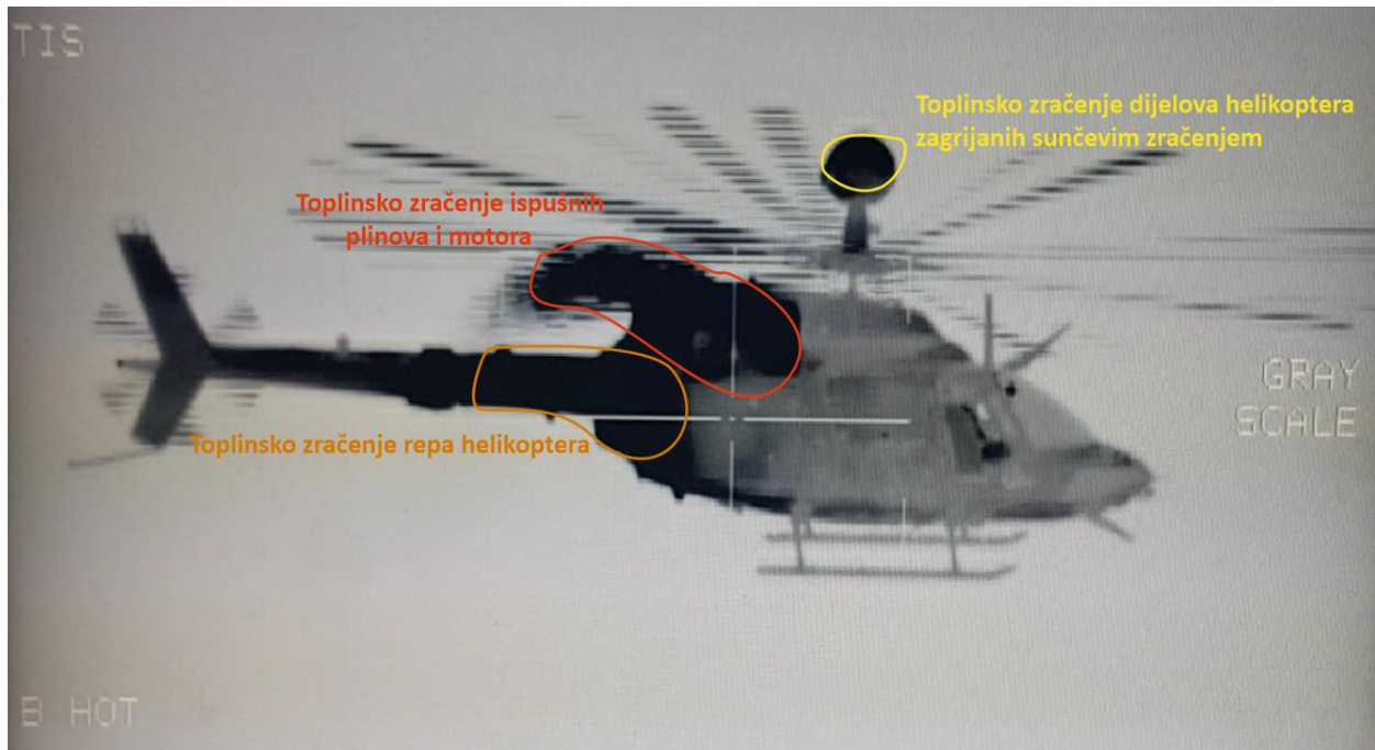
Slika 16. Bočno infracrveno zračenje helikoptera OH-58D Kiowa Warrior
