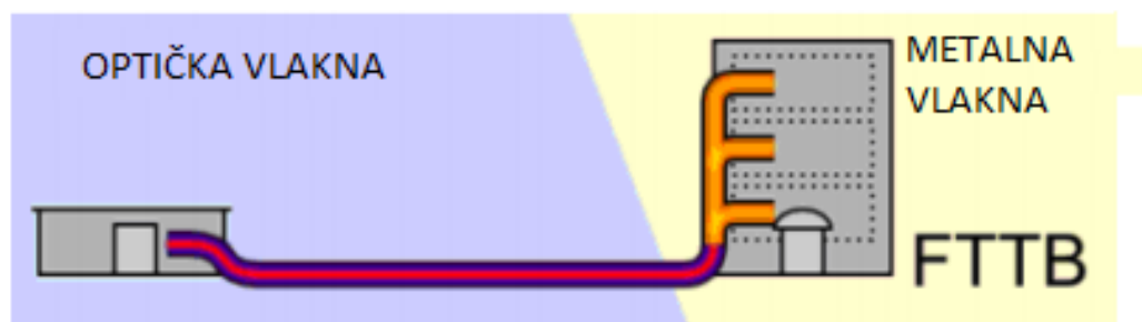
Slika 14 FTTB arhitektura do korisnika, izradio autor prema[24]
