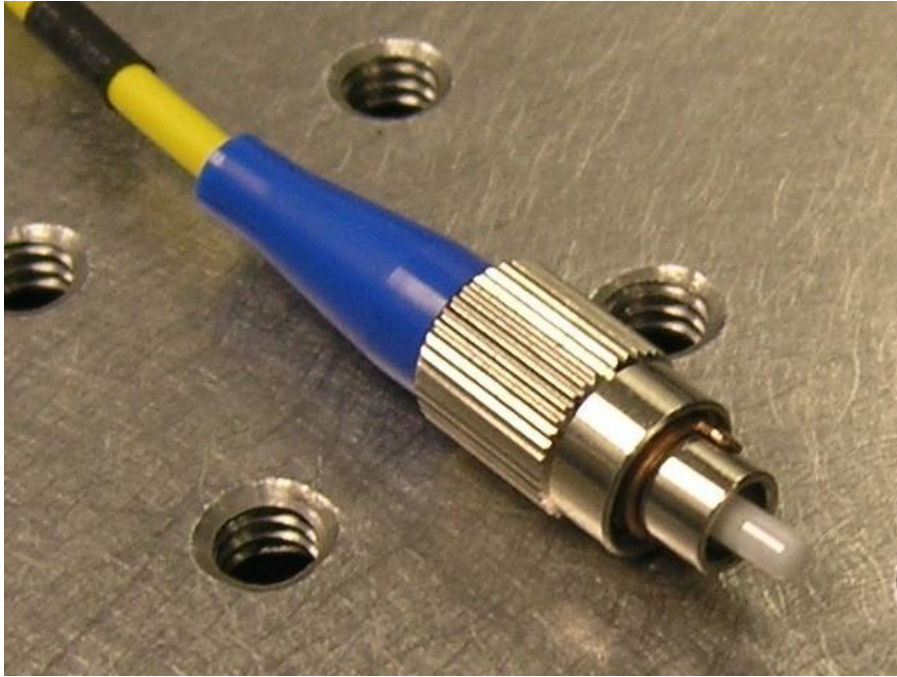
Slika 3 Prikaz FC konektora [7]
