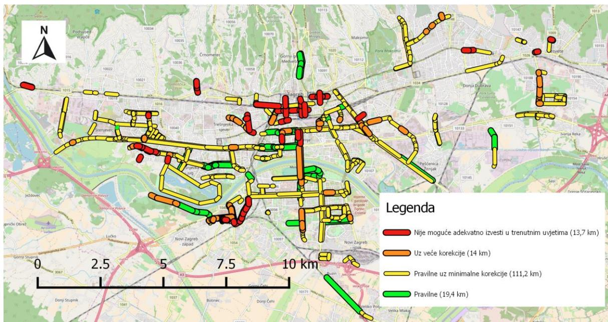
\*Minimalne korekcije pod uvjetom da na biciklističkom traku u Hebrangovojoj ulici u vršnom satu broj motornih vozila ne prelazi 700 voz/h i minimalne korekcije pod uvjetom da se na Zagrebačkoj aveniji toleriraju manji zaštitni pojasevi od ruba kolnika i rasvjetnih stupova kod desnih skretanja
