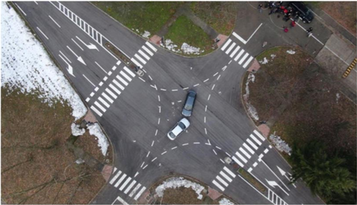
Slika 16. Prikaz rektificirane fotografije prometne nesreće putem bespilotne letjelice Izvor: Izradio autor
