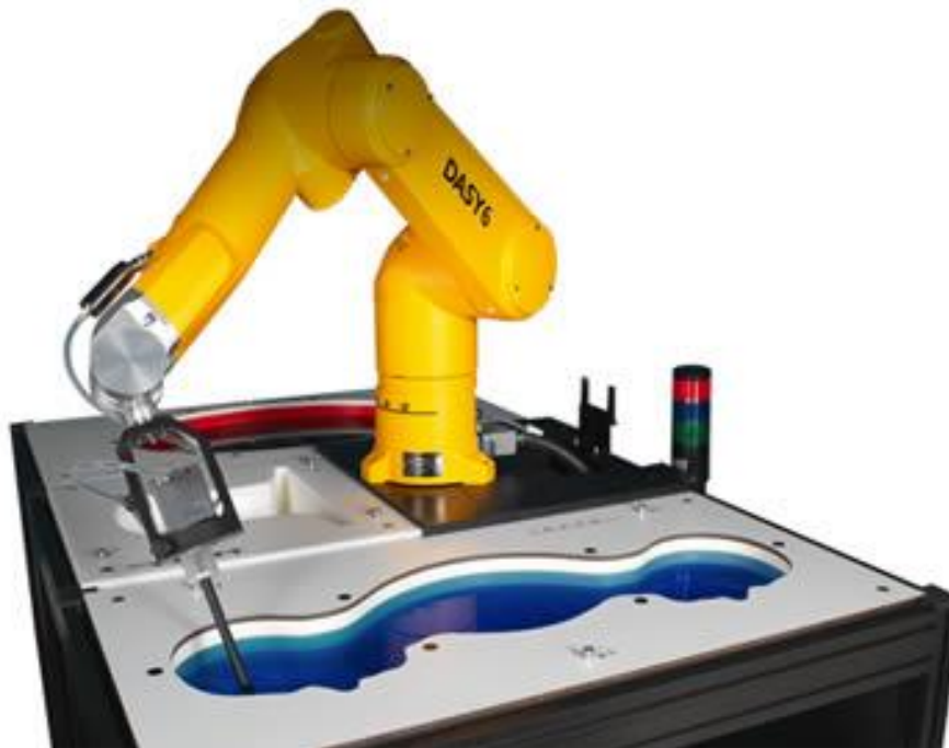
Slika 23: Testiranje zračenja na fantomskoj glavi, [51]
