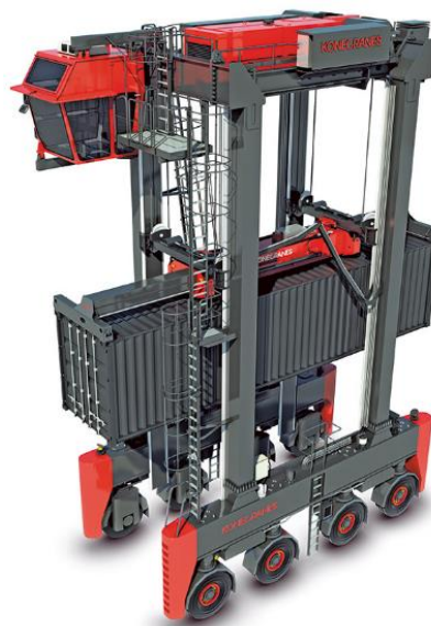
Slika 12. Portalni prijenosnik malog raspona
