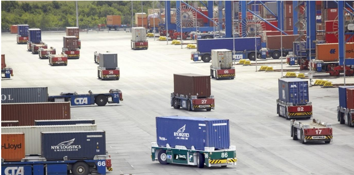
Slika 17. Automatizirani kontejnerski terminal Altenwerder (Hamburg)
