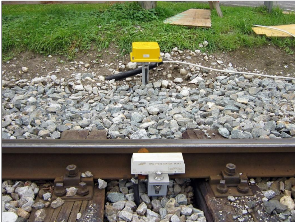
Slika 4. Moderni senzor željezničkog kotača [27]
