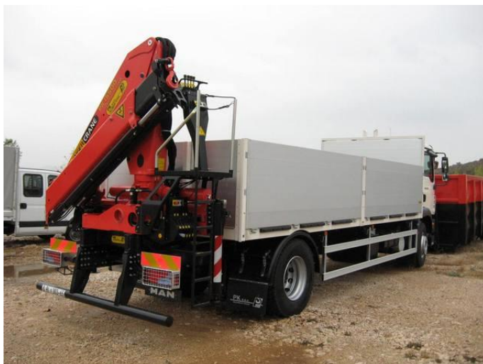
Slika 17.: PK1500 i tovarni sanduk na vozilu MAN TGM 18.180 4X2 BL Izvor: http://www.pk-rijeka.hr/isporuke/man-psc-crodux-plin/ (27.07.2017.)
