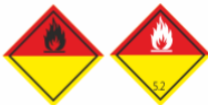
Slika 8.: Listica opasnosti za vozilo koje prevozi robu iz klase 5.2. Izvor: http://www.signalizacija.org/listice_sigurnosti.html , (27.07.2017.)
