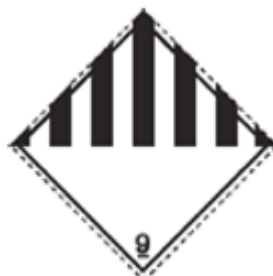
Slika 13. : Listice opasnosti za vozilo koje prevozi robu iz klase 9. Izvor: http://www.signalizacija.org/listice_sigurnosti.html , (27.07.2017.)
