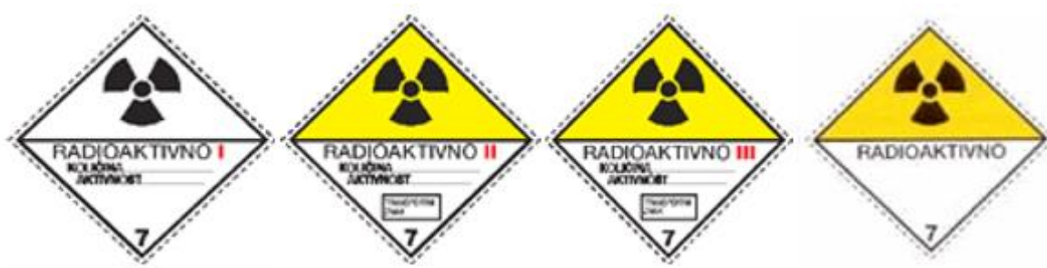
Slika 11.: Listice opasnosti za vozilo koje prevozi robu iz klase 7. Izvor: http://www.signalizacija.org/listice_sigurnosti.html , (01.08.2017.)
