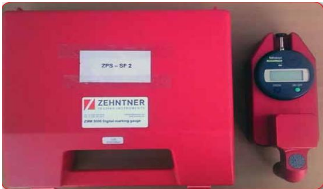
Slika 28: Uređaj za mjerenje debljine suhog filma boje
