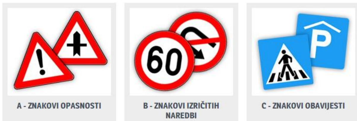
Slika 6: Prikaz znakova vertikalne signalizacije
