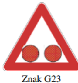
Slika 4: Svjetlosni znakovi za obilježavanje prijelaza ceste preko željezničke pruge
