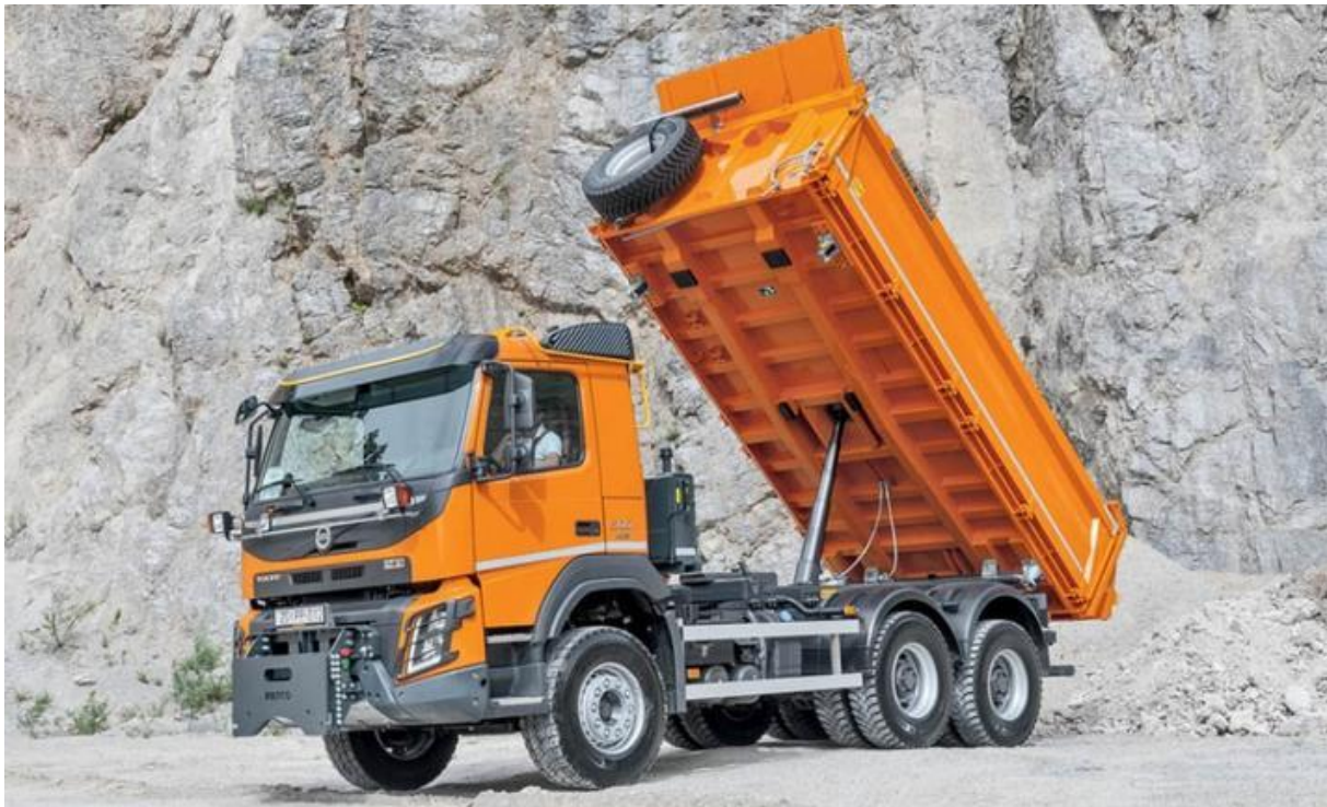
Slika 5: Primjer vozila sa otvorenim bočnim stranicama i hidrauličkim nagibnim cilindrom
