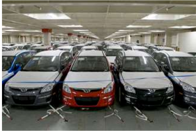
Slika 13. Učvršćivanje vozila na RO – RO brodovima
