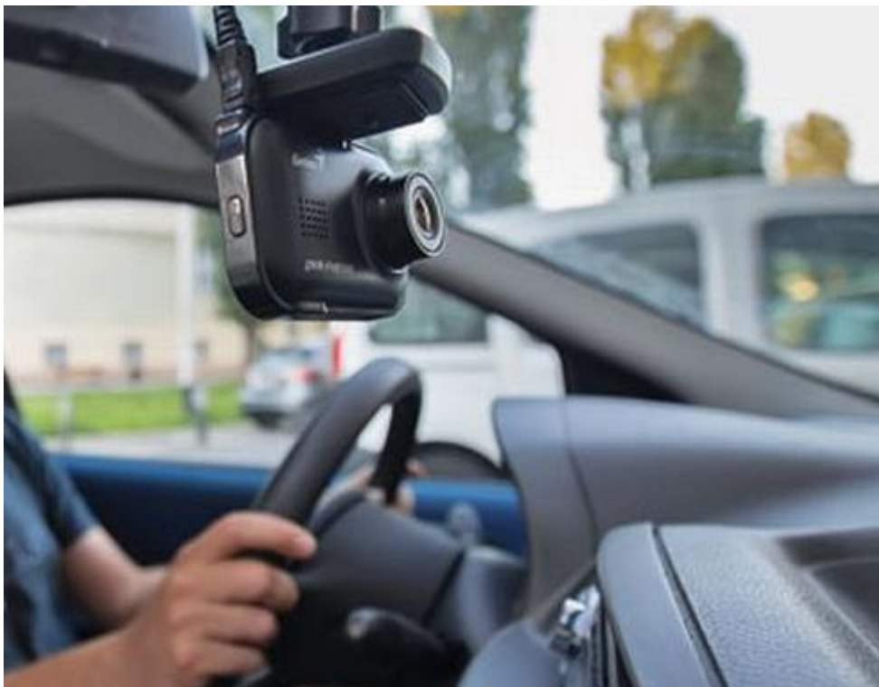
Slika 5.6 Položaj kamere za snimanje zadnjeg dijela vozila.
