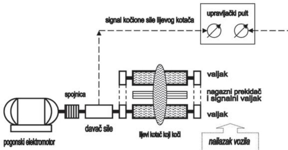
Slika 23. Shema valjaka za mjerjenje sile kočenja
