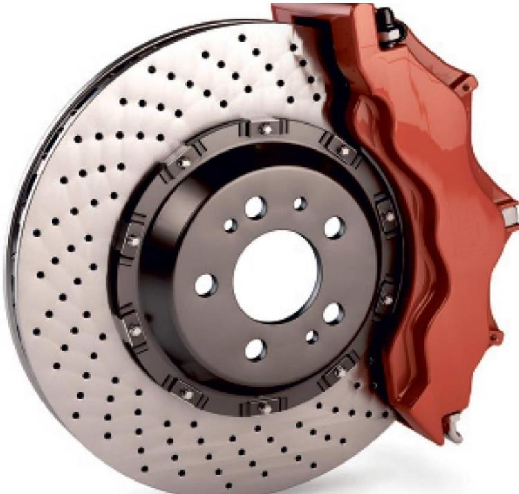
Slika 21. Ventilirajući kočni disk
