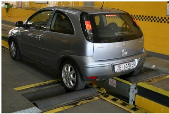
Slika 26. Vozila na valjcima za ispitivanje
