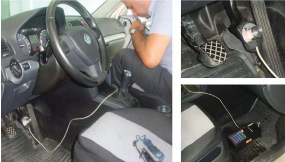
Slika 31. Postavljanje dinamometra i decelerometra u vozilo
