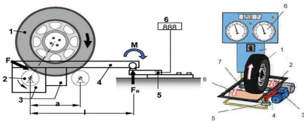
Slika 115. Načelna shema bokocrtka i prostornog izgleda valjaka za ispitivanje kočnica
