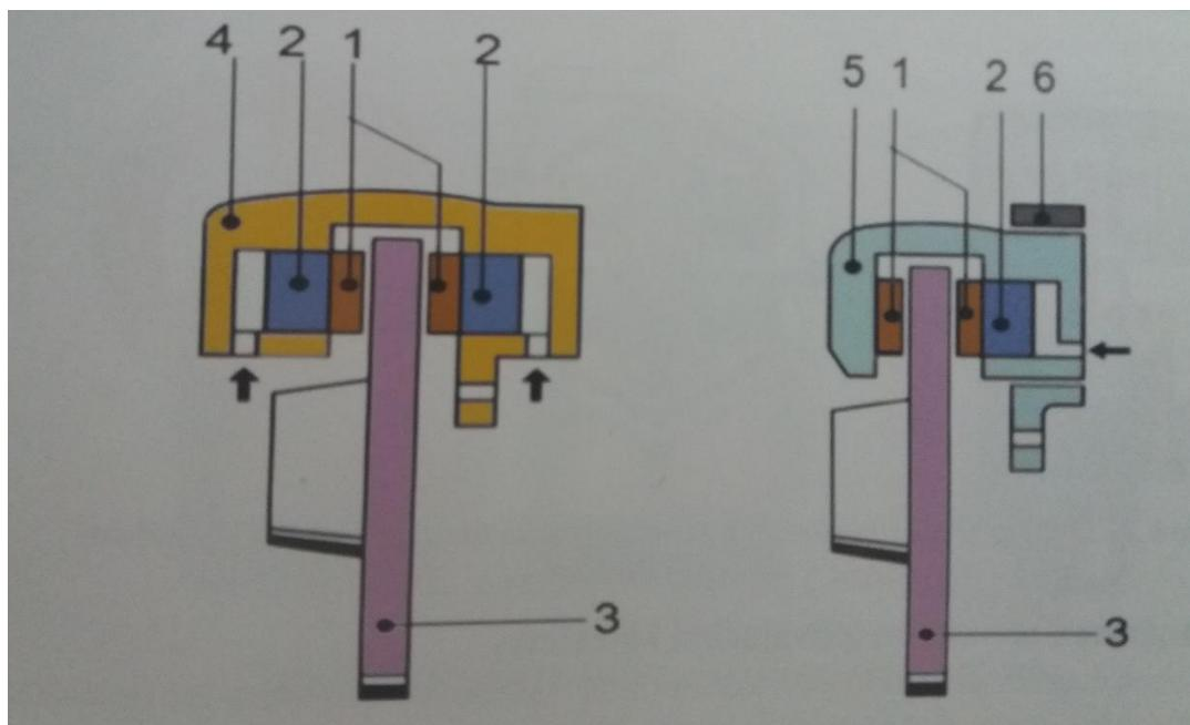
Slika 20. Disk kočnice s nepokretnim i pokretnim kliještim
