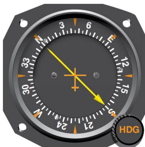
Slika 10. Pokazivač smjera NDB-a u zrakoplovu
