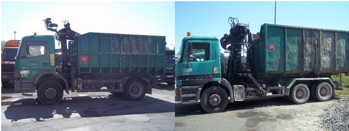
Slika 6. Kiper s dizalicom (utovarnom rukom), lijevo s dvije osovine, desno s tri
