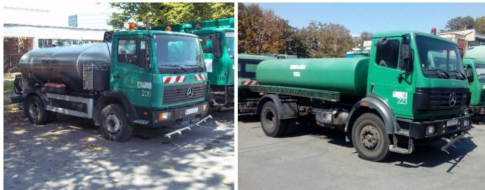
**Slika 9.** Cisterna lijevo  $5m^3$ , a desno  $7m^3$
