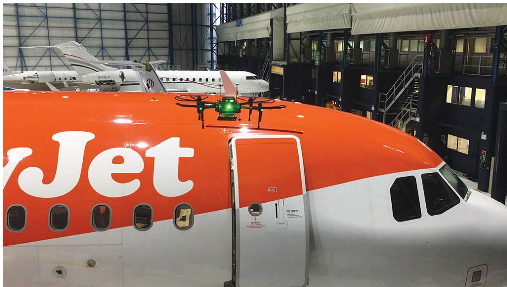
Slika 19. Dron Rapid u inspekciji EasyJet-ovog Airbusa A320
