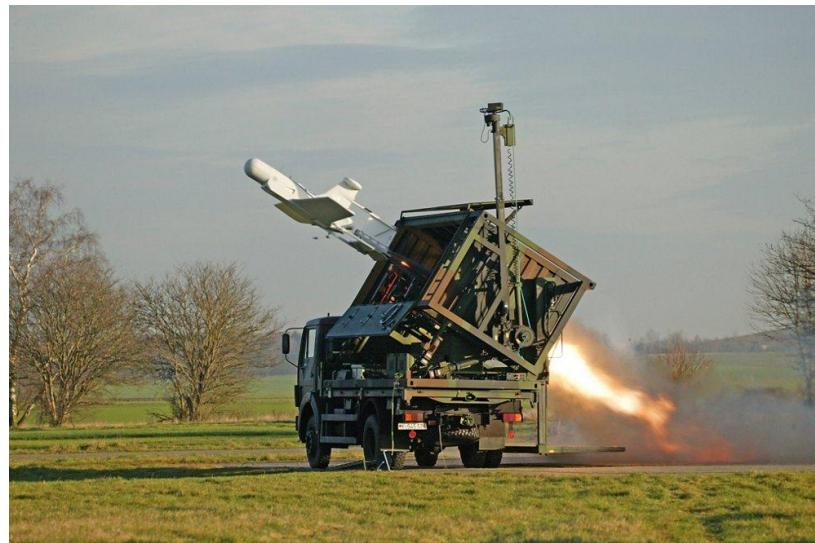
Slika 12. Bespilotna letjelica KZO s lansirnom rampom
