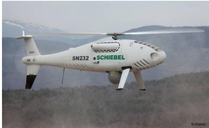
Slika 10. Bespilotna letjelica Camcopter S-100
