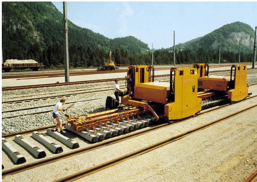
Slika 23. Stroj za pojedinačnu izmjenu pragova [6]
