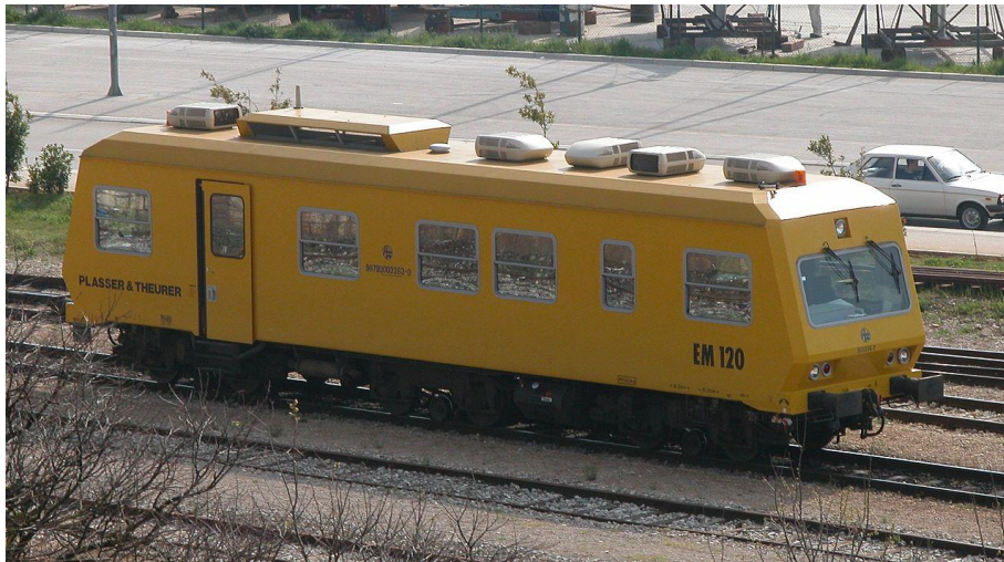
Slika 25. Mjerni vlak EM – 120 1
