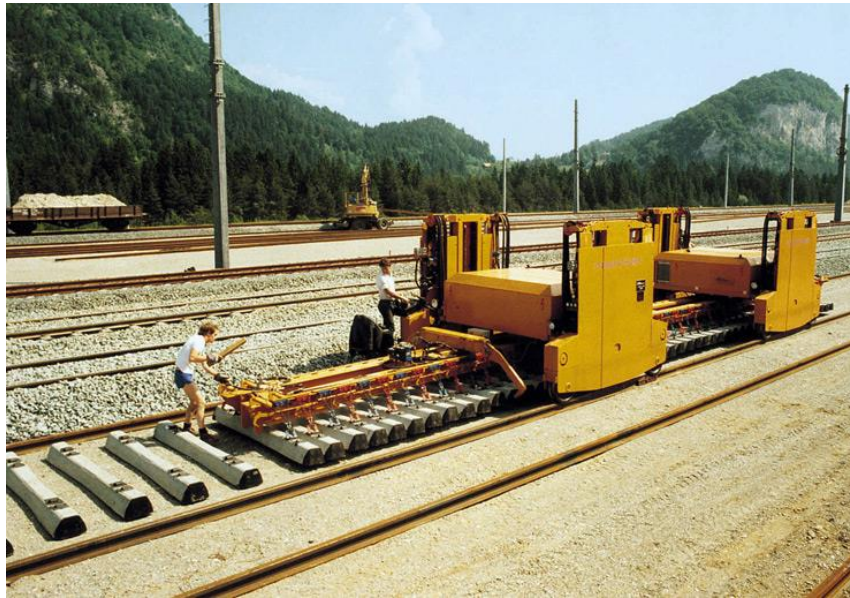
Slika 23. Stroj za pojedinačnu izmjenu pragova [6]
