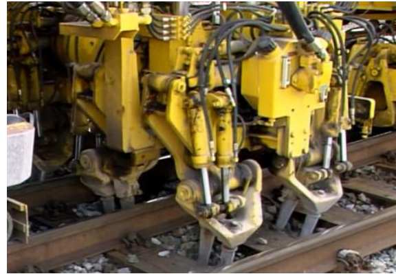
Slika 7. Podbijački agregat podbijačice [6]
