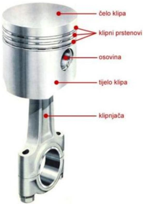
Slika 13. Klip, klipnjača, osovina i klipni prsteni, [8].
