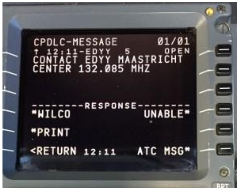
Slika 7. Prikaz CPDLC-a u kokpitu zrakoplova, [8]
