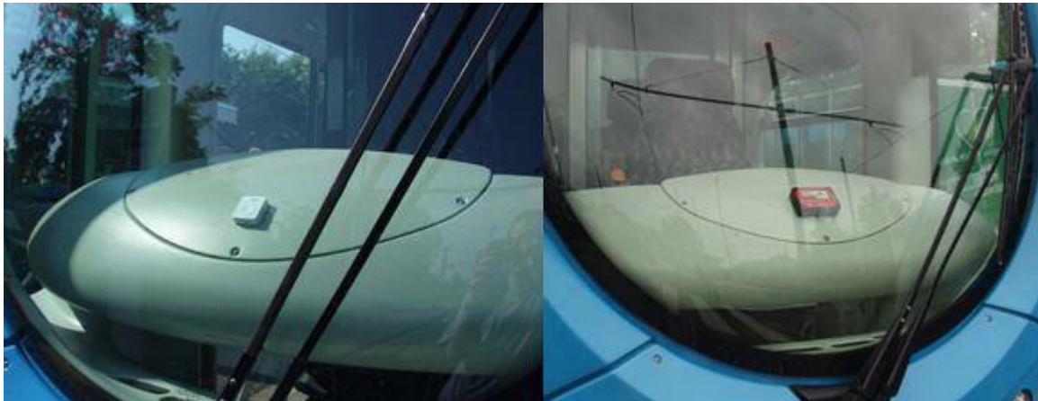
Slika 18. Položaj GPS uređaja u tramvaju
