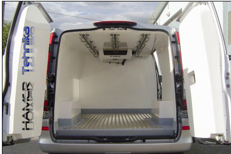
Slika 40. Prijevozno sredstvo s rashladnim uređajem, [50]
