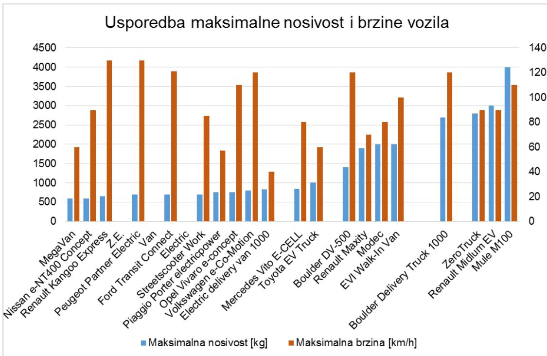
Grafikon 2. Usporedba maksimalne nosivost i brzine vozila
