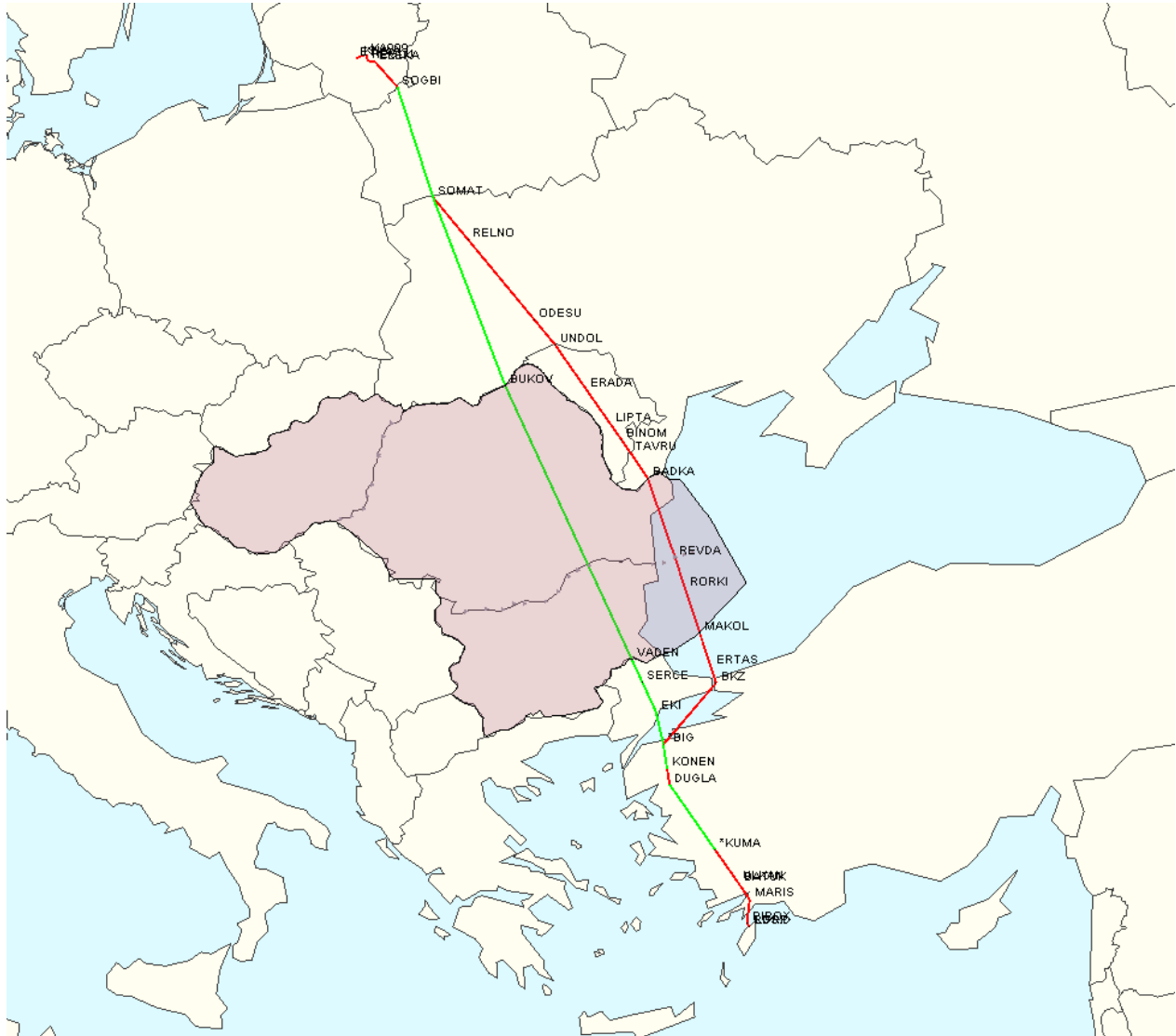
Slika 7. 2. Putanja leta RYR60HM prije (crvenom bojom) i nakon (zelenom bojom) implementacije FRA
