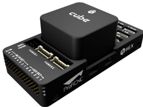
Slika 13 Pixhawk autopilotski modul, model 2.1 [21]
