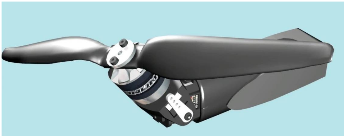
Slika 9 Koncept nosača motora [12]
