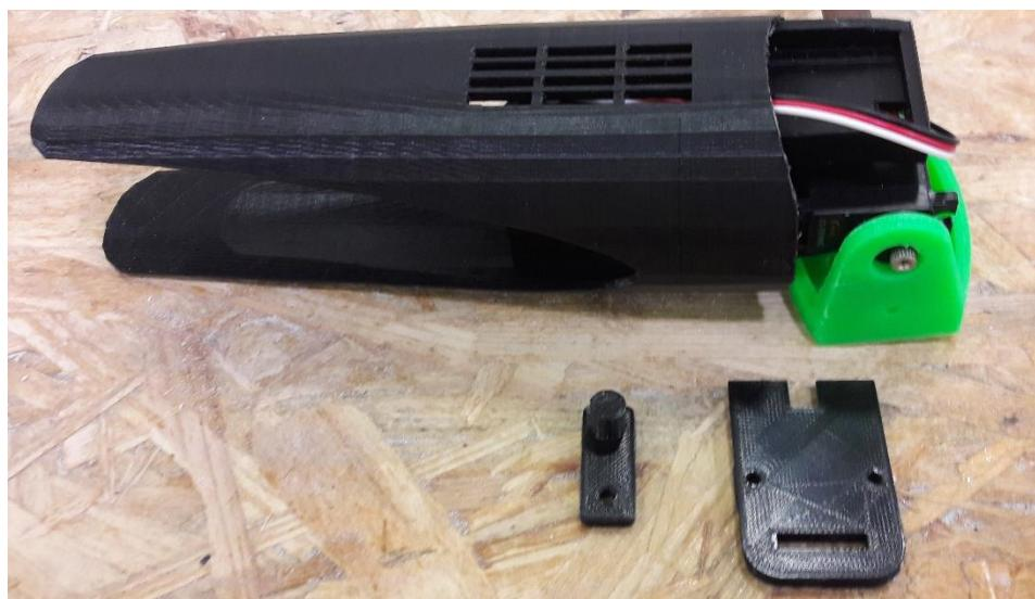
Slika 25 VTOL nosač i njegovi dijelovi
