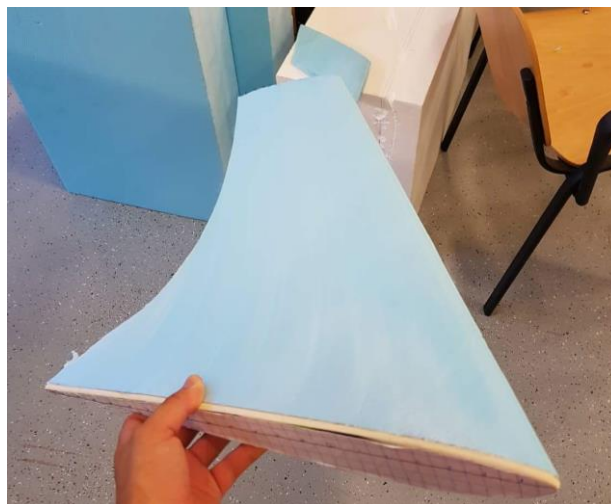
Slika 20 Neuspjeli pokušaj rezanja strukture krila
