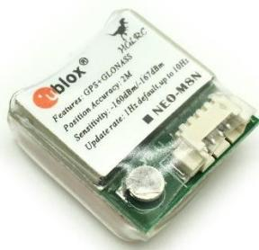
*Slika 12 Neke od izvedbi GPS-a za bespilotne letjelice [20]*
