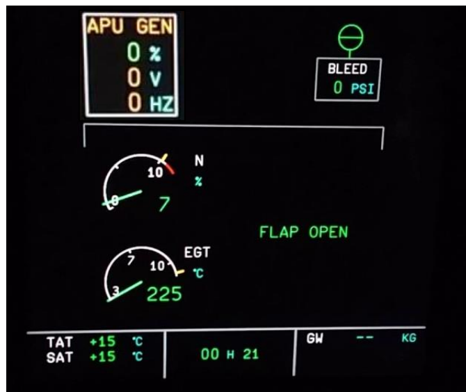
Slika 7. Porast brzine vrtnje i temperature ispušnih plinova APU-a
