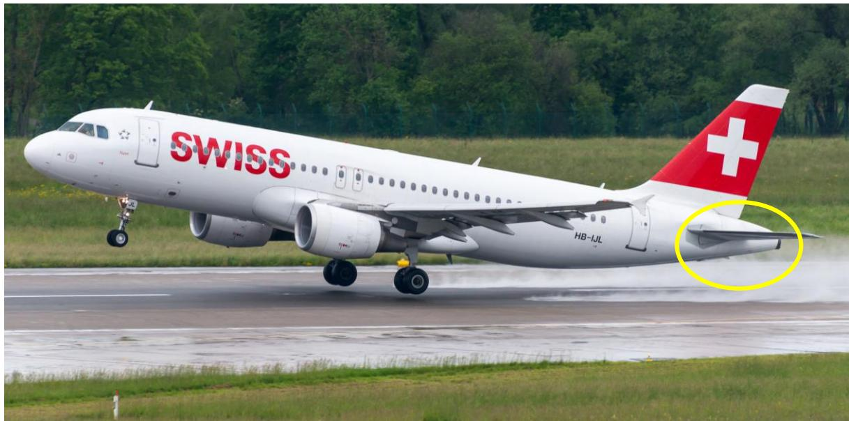
Slika 1. Smještaj APU-a na zrakoplovu Airbus A320
