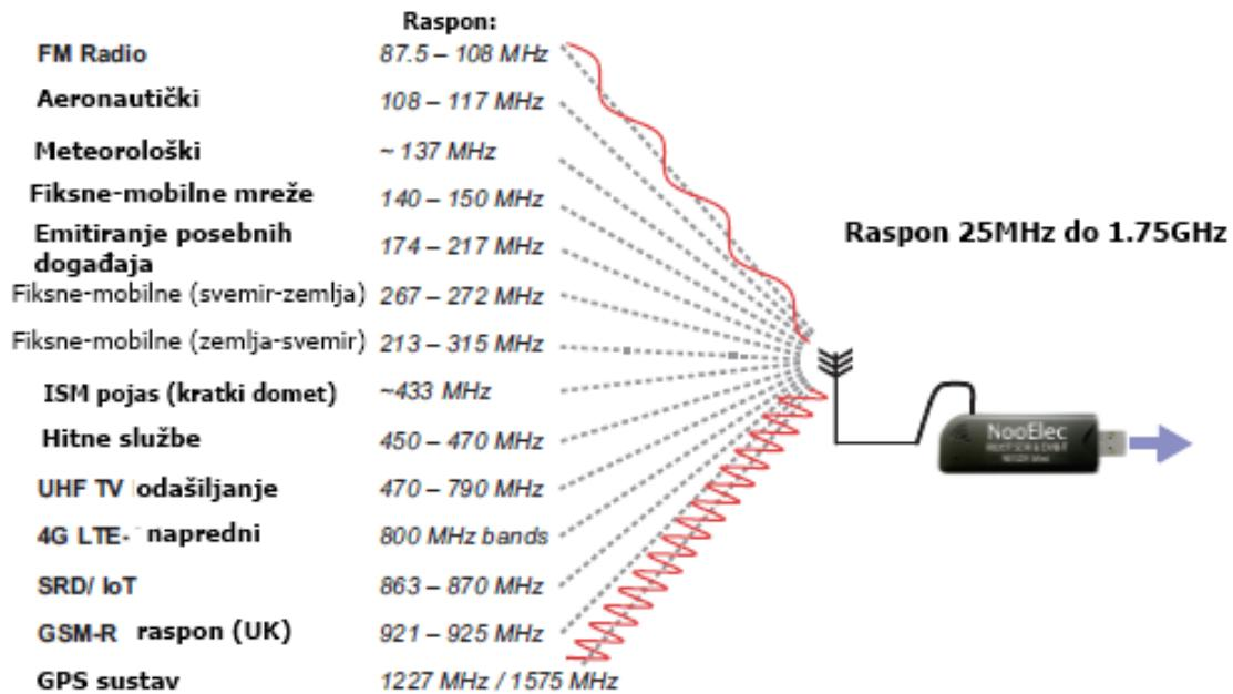
*Slika 9: Primjer signala dostupnih za očitavanje SDR sustavom, [16]*
