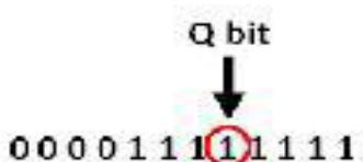
Slika 3: Primjer "Q-bit-a" u podatkovnom bloku za visinu zrakoplova, [9]
