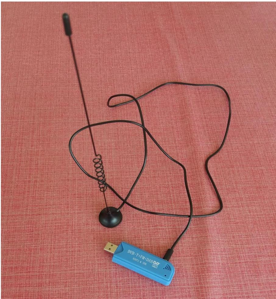
Slika 19: RTL-SDR uređaj
