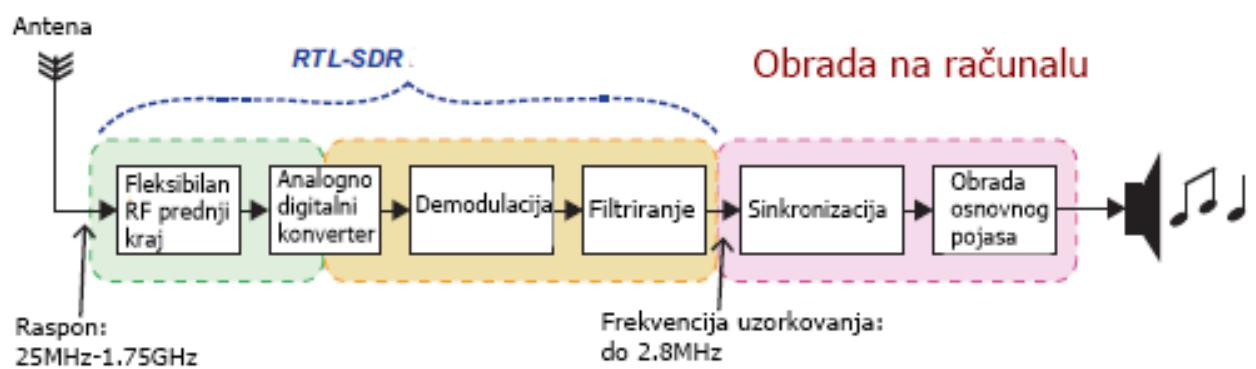
*Slika 8: Cjelokupni proces obrade signala SDR sustavom, [16]*
