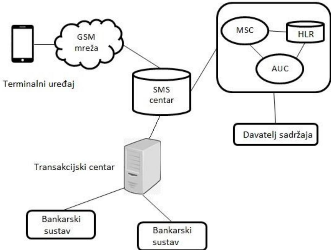
Slika 2 Standardni format slanja SMS poruke za plaćanje usluge
