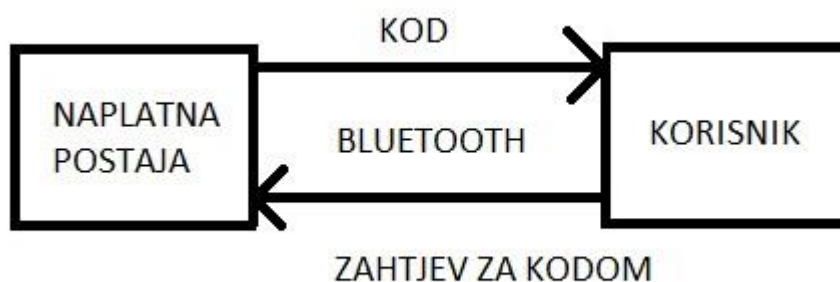
Slika 16 Arhitektura plaćanja aplikacijom kod ulazne naplatne postaje
