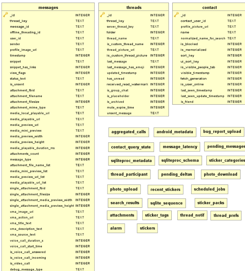
Grafikon 2. Struktura baze podataka “ core.db ” dobivena korištenjem alata DbVisualizer
