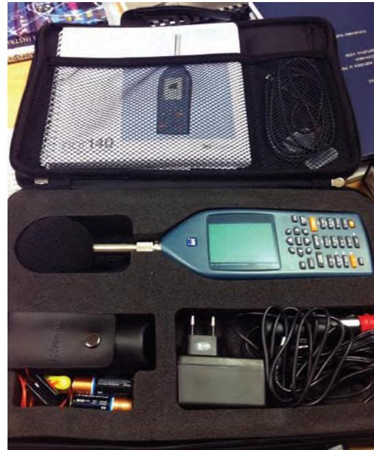
**Slika 9.** Prikaz pozicije instrumenta u zrakoplovu prilikom mjerena te mjerni instrument sa pripadajućom opremom
