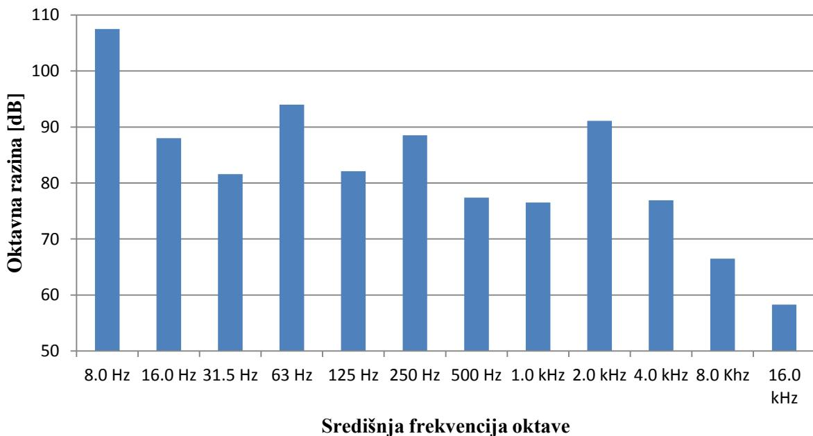
**Slika 21.** Grafikon unutarnjeg oktavnog mjernja buke zrakoplova
