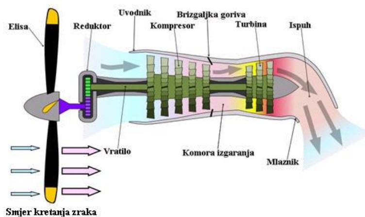
**Slika 8.** Ilustracija turbo-prop motora sa označenim dijelovima
