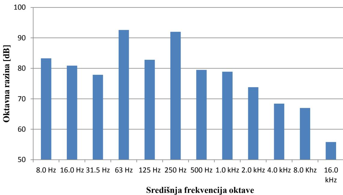
**Slika 22.** Grafikon unutarnjeg oktavnog mjernja buke zrakoplova
