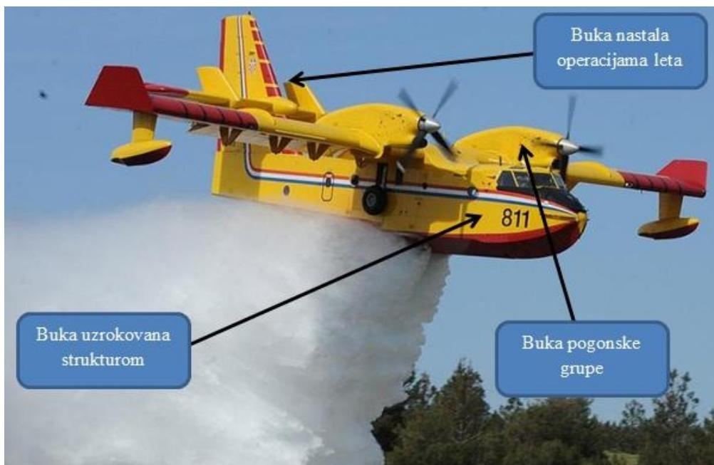
**Slika 6.** Izvori buke na zrakoplovu [ Izvor: [www.airliners.net](http://www.airliners.net) ]
