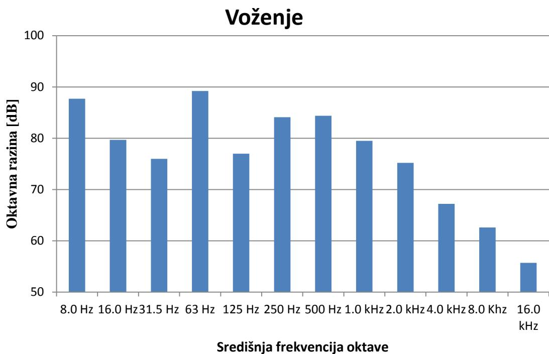
**Slika 16.** Grafikon unutarnjeg oktavnog mjerjenja buke zrakoplova CL-415 u voženju.
