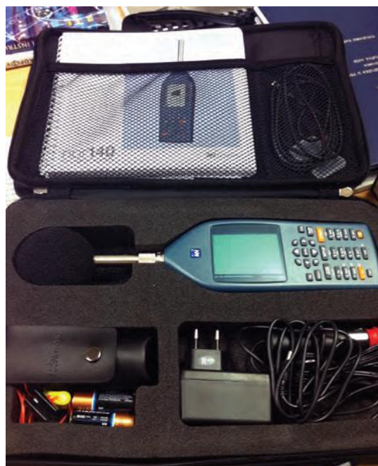
Slika 9. Prikaz pozicije instrumenta u zrakoplovu prilikom mjerenja te mjerni instrument sa pripadajućom opremom
