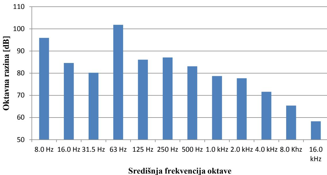
**Slika 24.** Grafikon unutarnjeg oktavnog mjernja buke zrakoplova CL-415 na slijetanju
