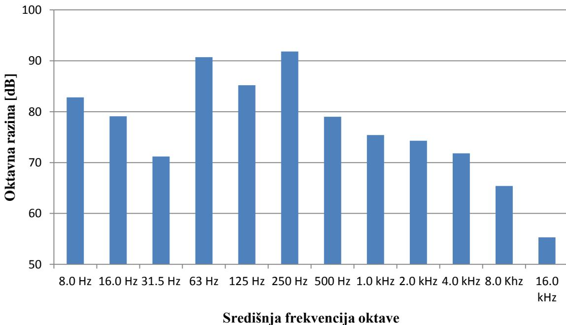
**Slika 23.** Grafikon unutarnjeg oktavnog mjernja buke zrakoplova CL-415 u prilazu za slijetanje.
