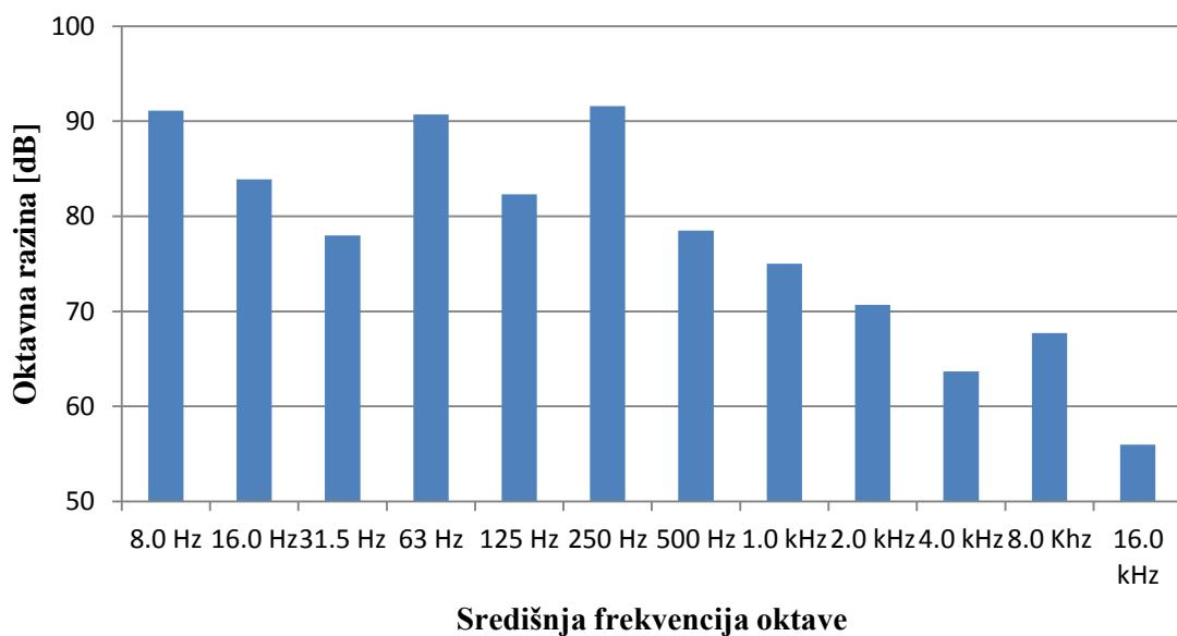
**Slika 18.** Grafikon unutarnjeg oktavnog mjernja buke zrakoplova CL-415 u penjanju.
