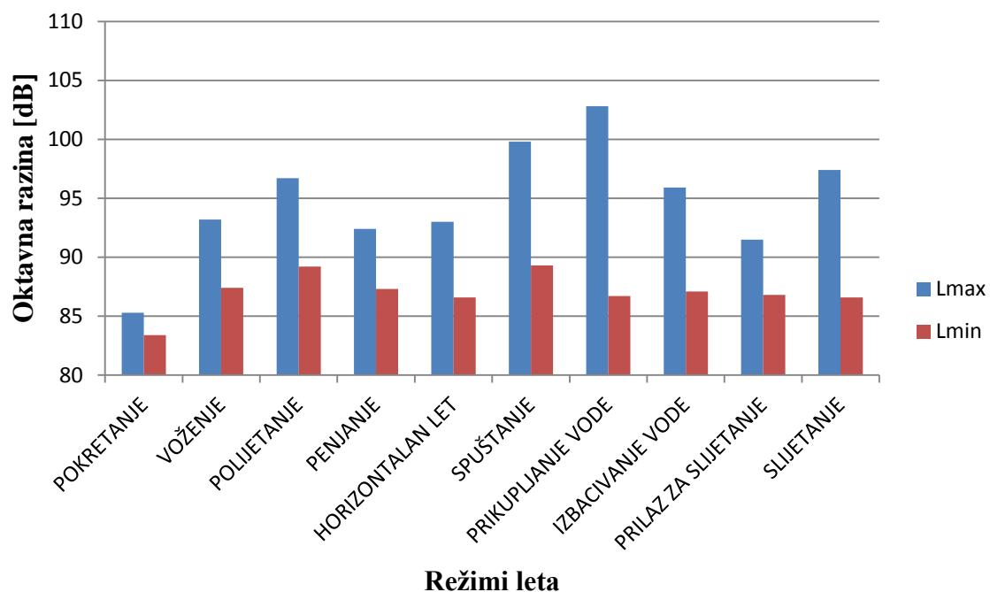
**Slika 11.** Grafikon unutarnje buke zrakoplova CL-415 mjerene A-ponderiranom metodom
