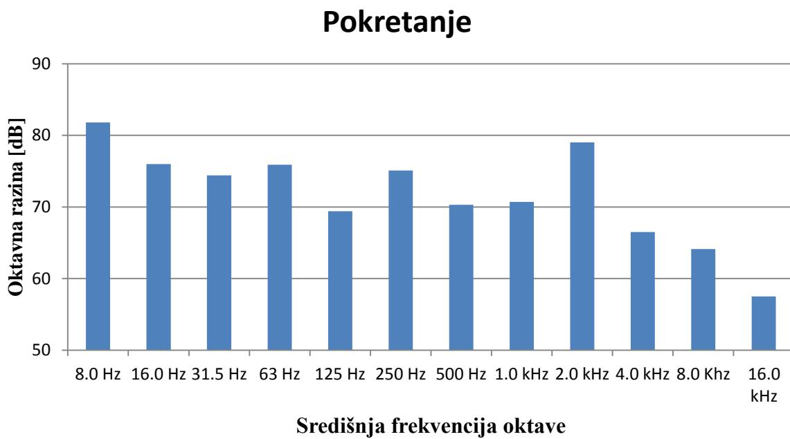
**Slika 15.** Grafikon unutarnjeg oktavnog mjerjenja buke zrakoplova CL-415 na pokretanju.
