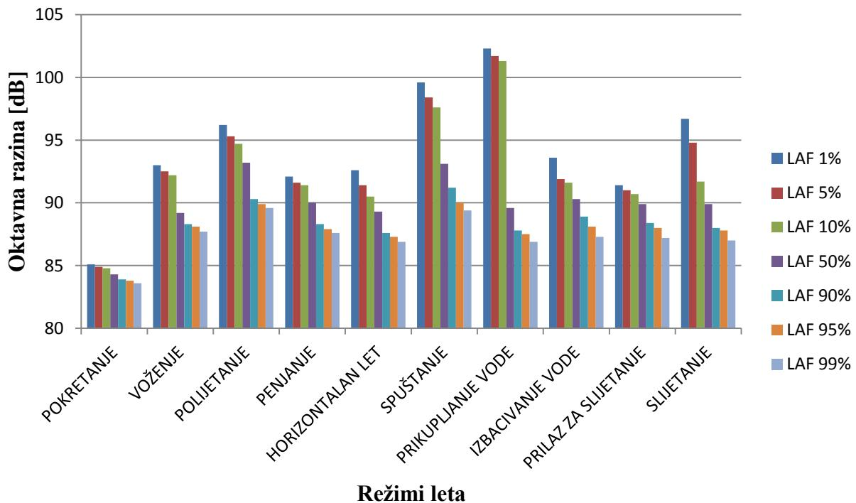
**Slika 13.** Grafikon unutarnje buke zrakoplova CL-415 mjerene A-ponderiranom metodom u postotcima za sve režime
