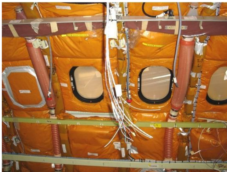
Slika 29. Primjer oblaganja kabine zrakoplova u svrhu smanjenja unutarnje kabinske buke
