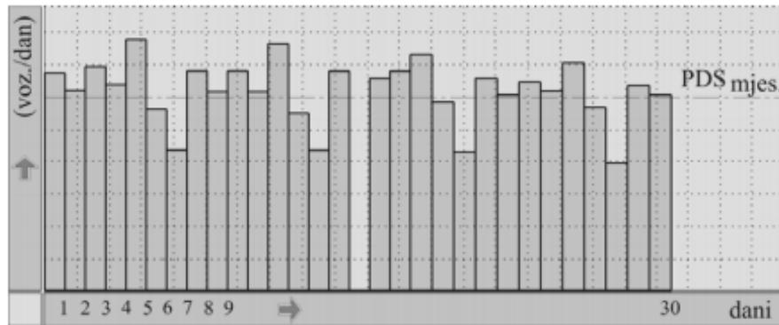
Slika 15 Dnevna neavnomjernost protoka vozila u periodu jednog mjeseca
