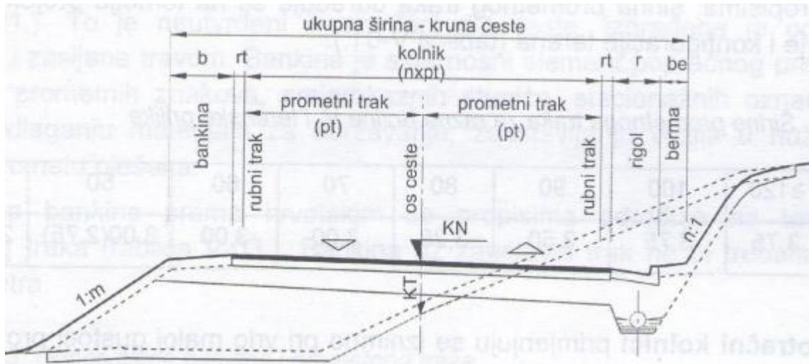
Slika 21 Osnovni elementi poprečnog presjeka ceste u zavoju
