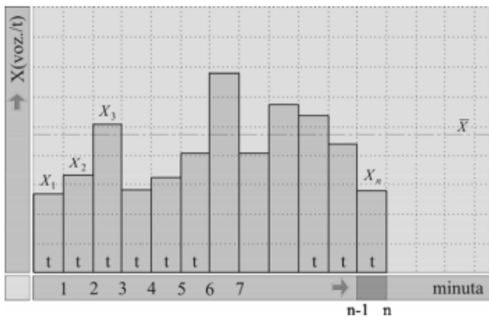
Slika 18 Neravnomjernosti protoka po manjim vremenskim jedinicama od jednog sata
