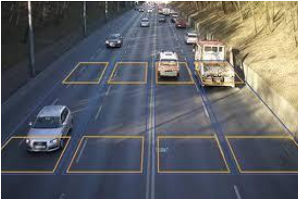
Slika 5.1. Primjer „virtualne petlje“ video detektora
