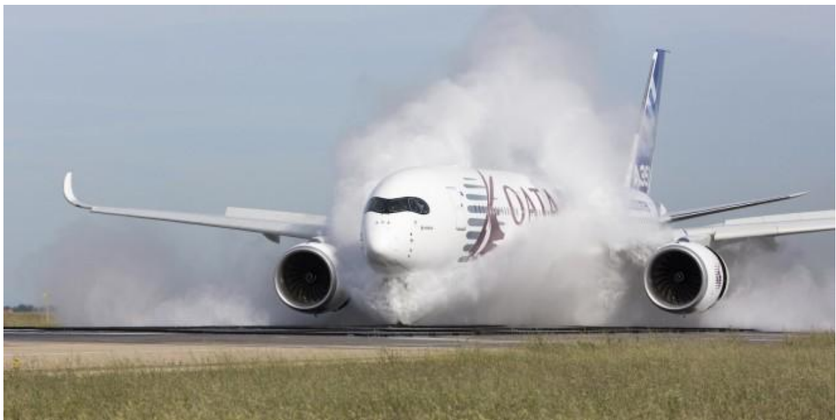
Slika 9. – Stajaća voda na uzletno - sletnoj stazi 9
