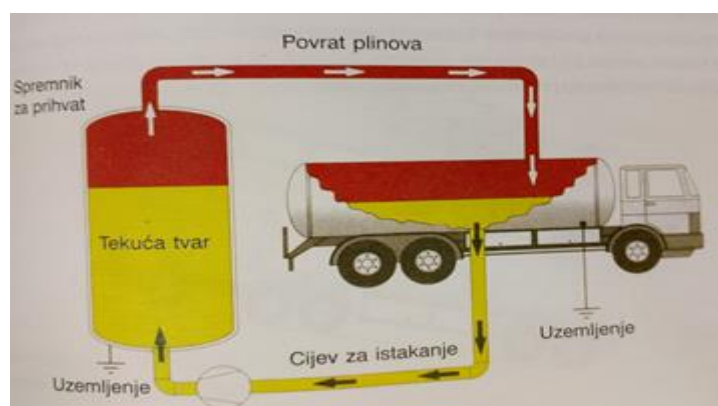
Slika 11: Pražnjenje cisterne zatvorenim EKO sustavom
