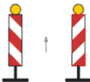
Slika 18.: Ploča za obilježavanje mjesta izvođenja radova na cesti ili oštećenja kolnika [1]
