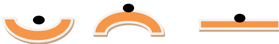
Slika 1. Stabilnost, labilnost i indiferentnost Izvor: [1]
