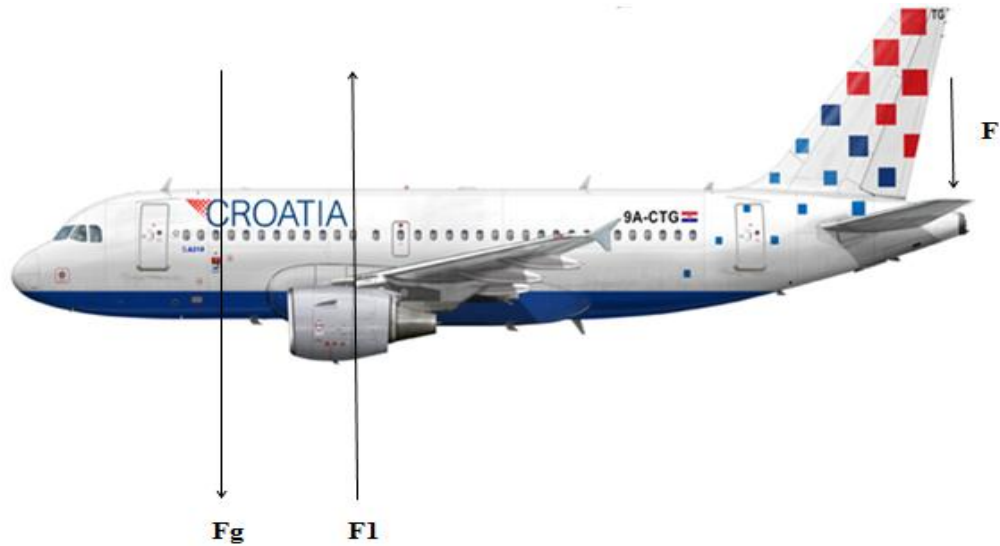
Slika 13. Težište zrakoplova pomaknuto prema unazad Izvor: [12]
