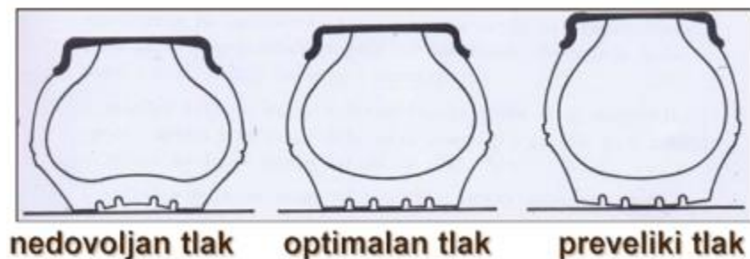
Slika 17. Tlak zraka u pneumaticima [7]
