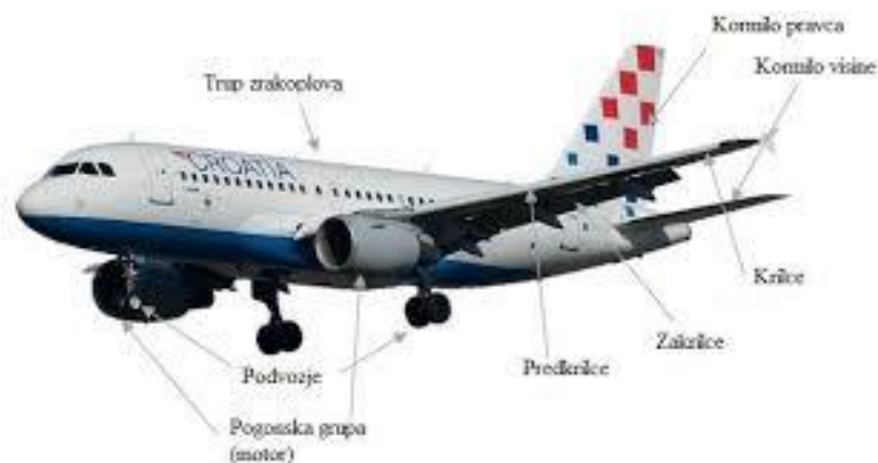
Slika 2. Prikaz izvora buke na zrakoplovu, [18]
