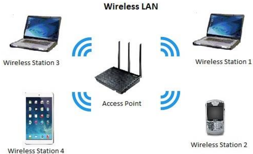
Slika 6. Prikaz bežičnog povezivanja na pristupnu točku u WLAN mreži
