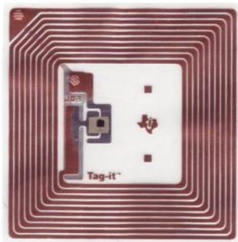
Slika 7. RFID transponder- antena i mikročip
