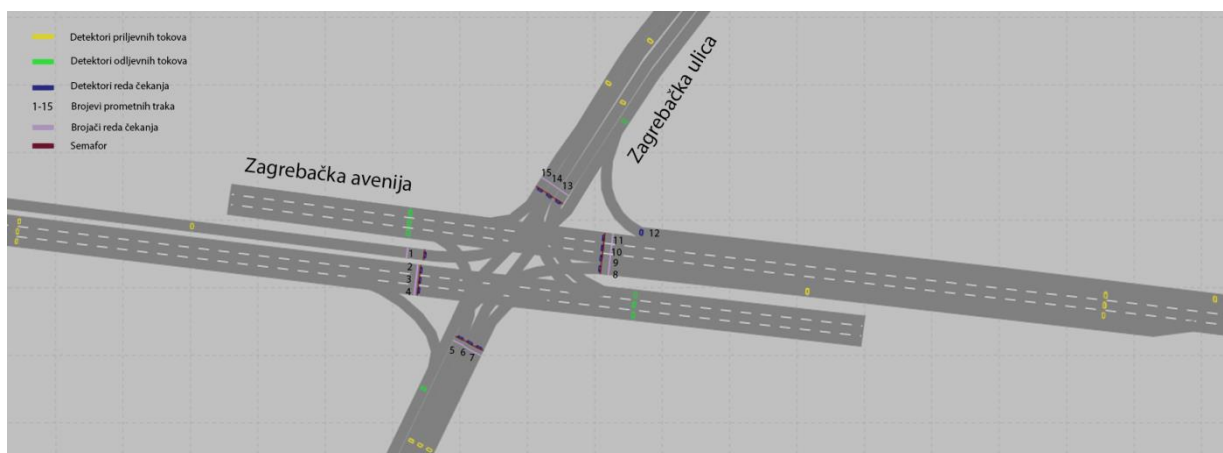
Slika 9. Prikaz označavanja detektora unutar modela semaforiziranog raskrižja
