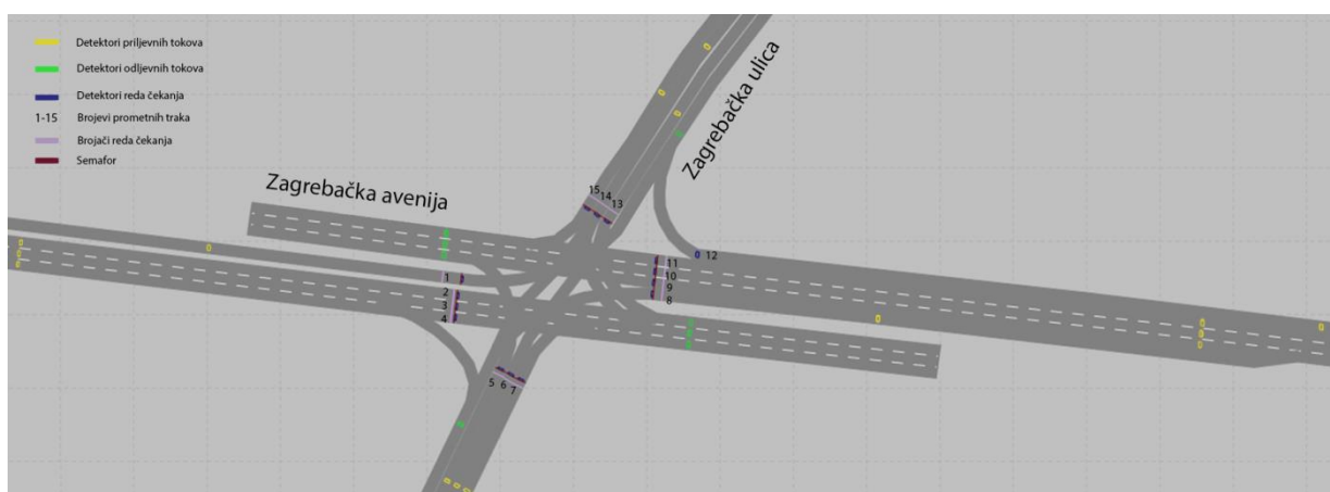
Slika 9. Prikaz označavanja detektora unutar modela semaforiziranog raskrižja
