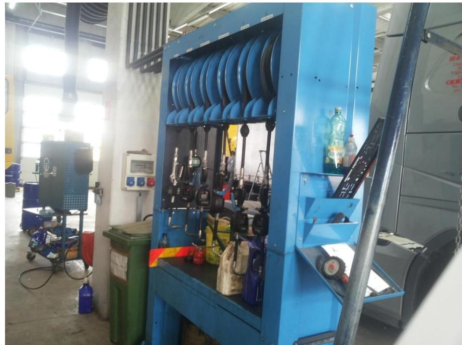
Slika 17 Aparat za dovod ulja
