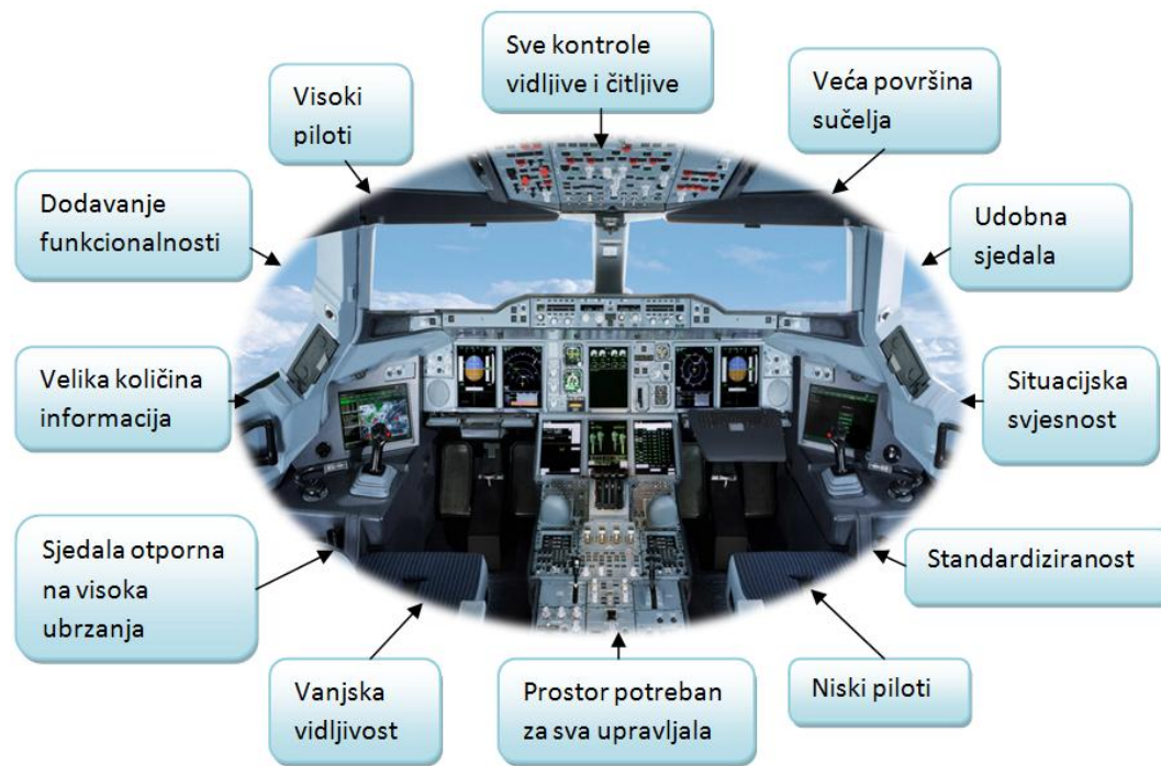
Slika 3.3. Komplementarni ciljevi dizajna pilotske kabine
