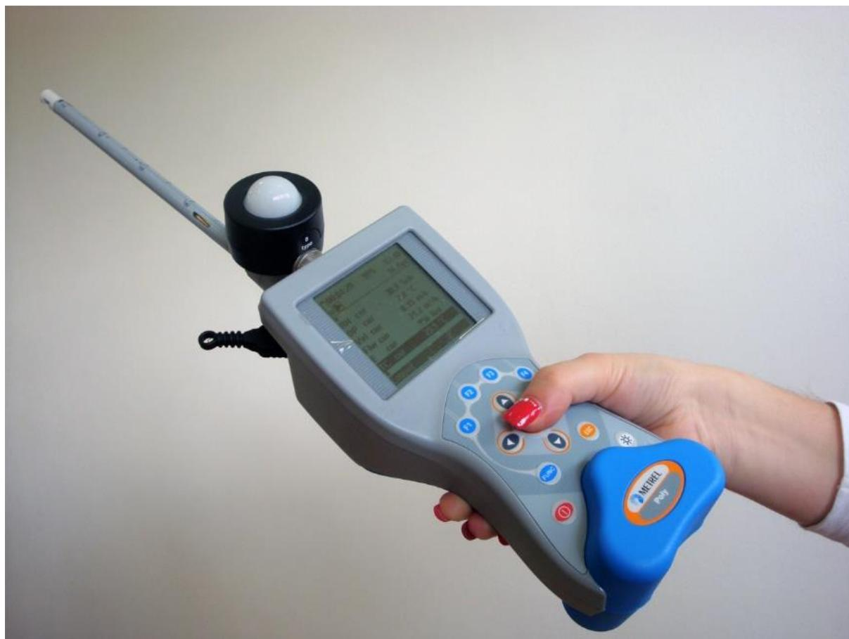
Slika 4.15. Kalibrirani prijenosni digitalni višenamjenski ručni instrument Metrel Poly MI 6401 EU za mjerjenje parametara okoliša.
