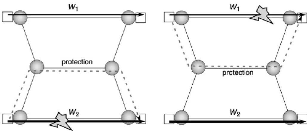
Slika 21: Grafički prikaz zaštite dijeljenjem puta, [32]
