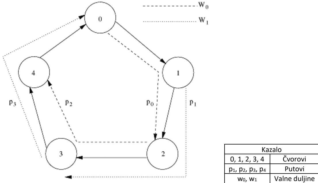
Slika 26: Shematski prikaz mreže s valnim usmjerenjem [34]
