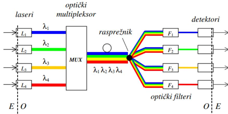
Slika 2: Shematski prikaz komponenti potrebnih za ostvarenje WDM-a, [5]
