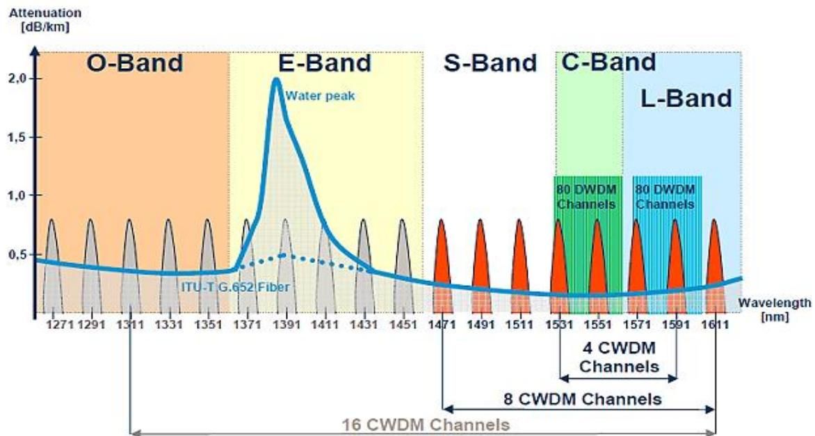
Slika 16: Grafički prikaz CWDM kanala i optičkih pojaseva, [29]
