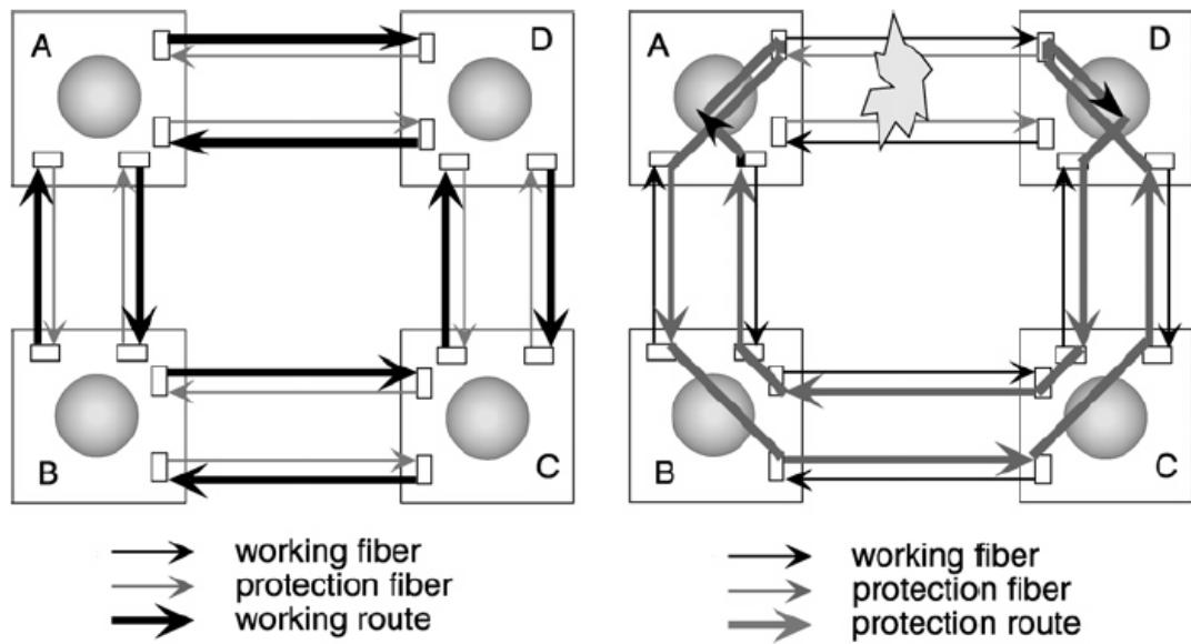
Slika 19: Shematski prikaz OMS-SPRing mehanizma zaštite, [32]
