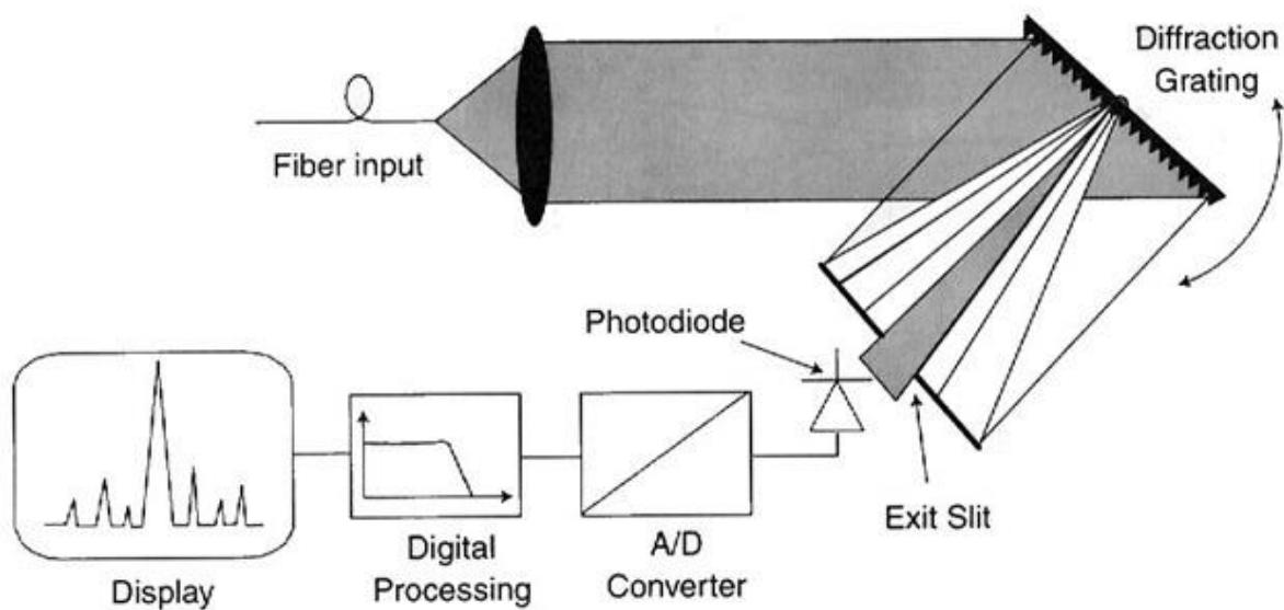
Slika 14: Shematski prikaz demultiplesiranja pomoću difrakcijske rešetke, [26]
