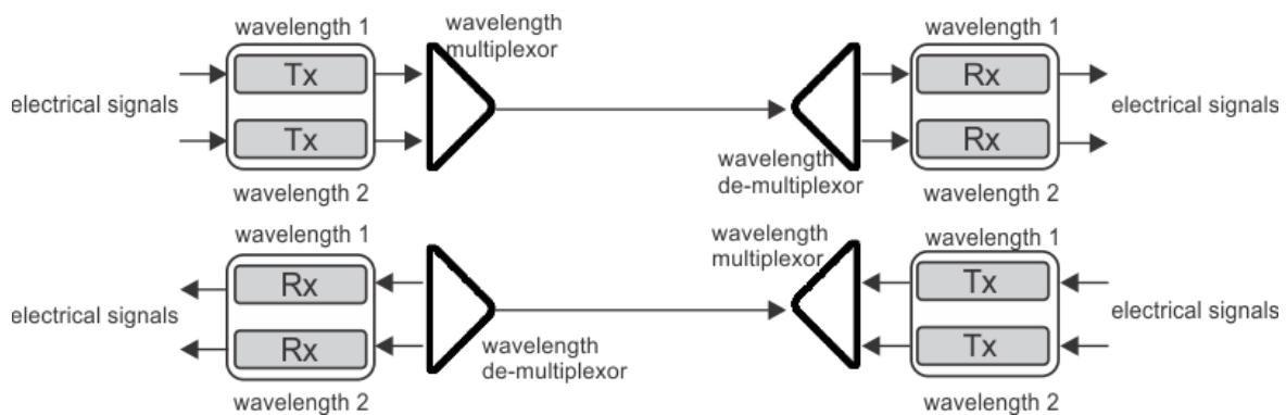
Slika 11: Shematski prikaz jednosmjernog WDM sustava, [22]
