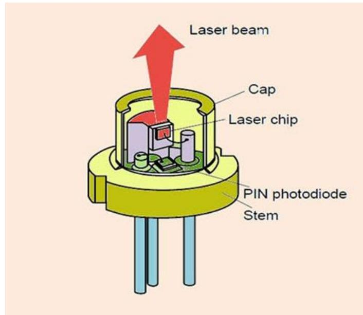
Slika 8: Laser dioda, [18]
