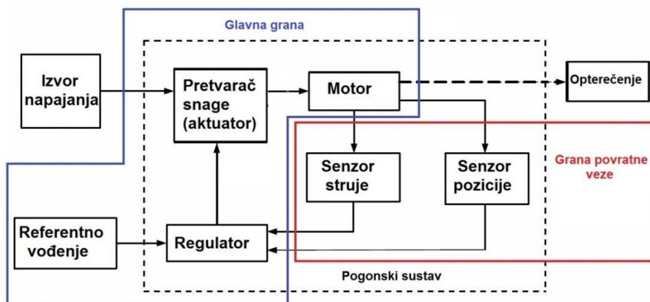
Slika 4. Sustav upravljanja pogonom reluktantnog motora (3)
