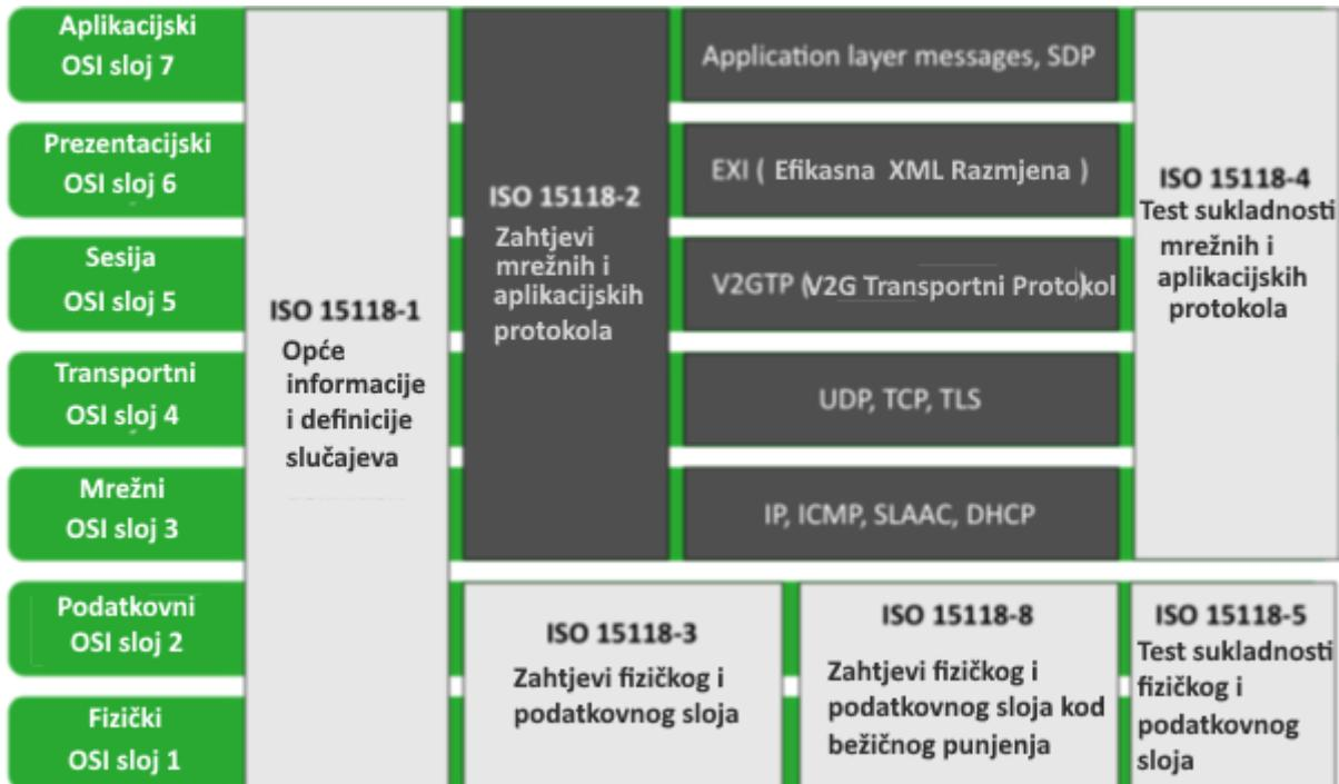
Slika 7. OSI model *Vehicle to grid* komunikacije (11)
