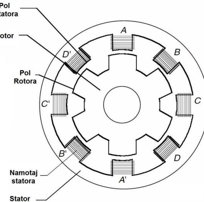
Slika 3. Presjek reluktantnog motora (3)
