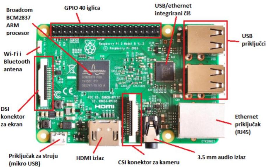
Slika 12. Osnovne komponente Raspberry Pi uređaja (16)
