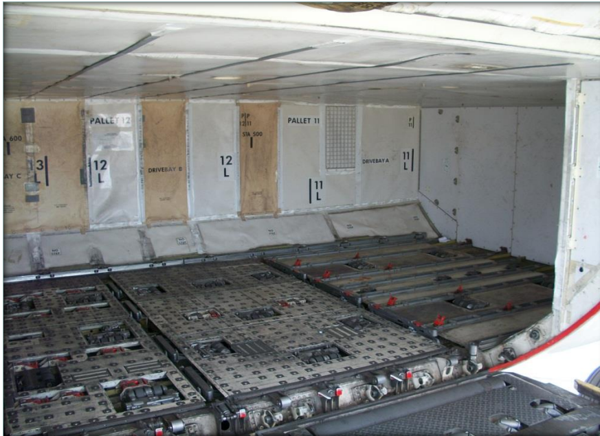
Slika 21. Prednji prtljažni prostor zrakoplova B777 Izvor: Emirates, Ground Operations Manual, revision nr. 10, ožujak 2018.
