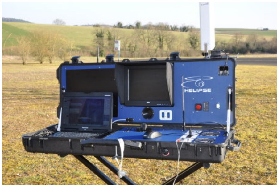
Slika 10. Zemaljska stanica za kontrolu proizvođača HELIPSE
