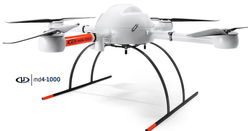
Slika 20. Dron MD4-1000 korišten u lociranju novih položaja minsko sumnjivih područja
