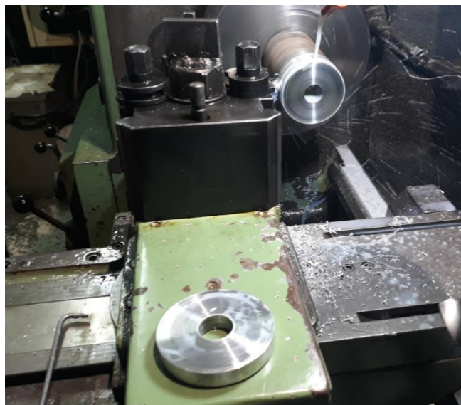
Slika 4.32. Rezanje montažnih diskova na tokarilici
