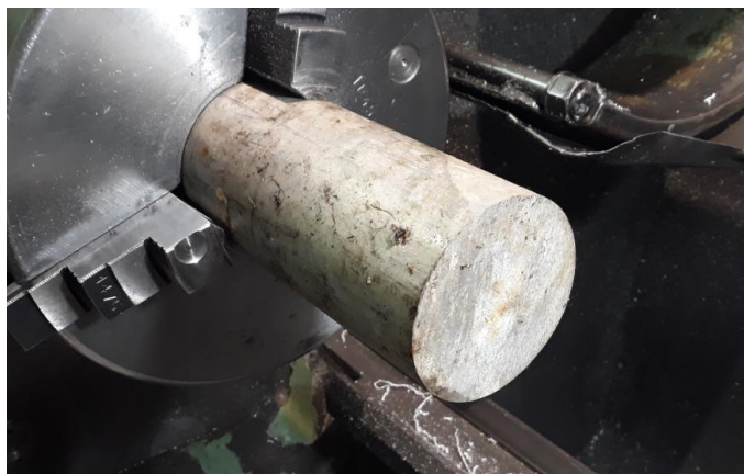
Slika 4.31. Aluminijski valjak na tokarilici - početak izrade montažnih diskova
