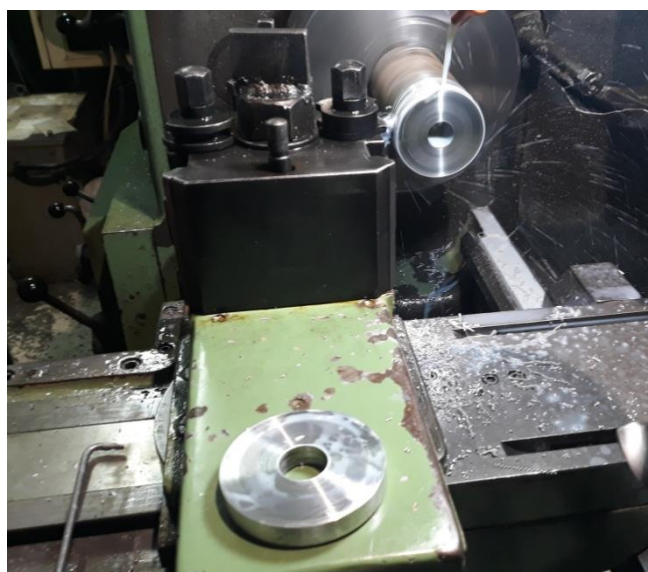
Slika 4.32. Rezanje montažnih diskova na tokarilici
