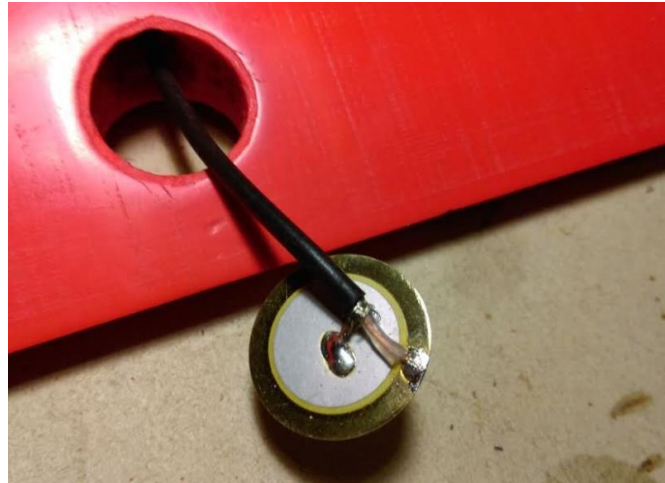
Slika 4.38. Spajanje senzora i koaksijalnog kabla
