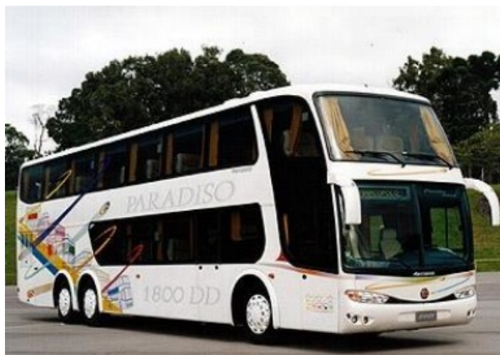
Slika 11. Primjer izvedbe katnoga troosovinskog autobusa turističke namjene
